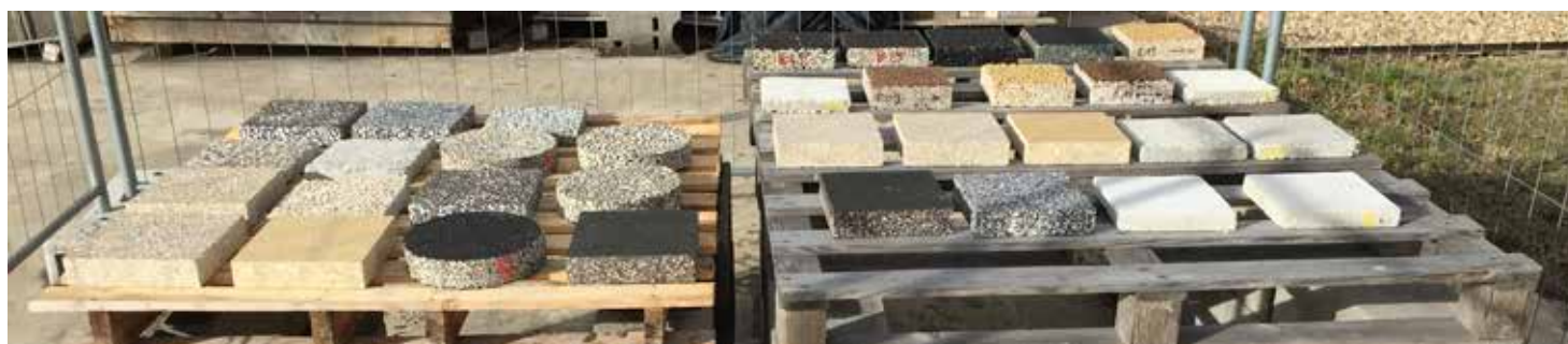
Lot de revêtements actuellement soumis aux intempéries.
